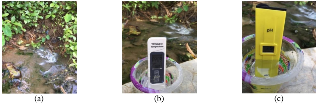
Gambar 6. (a) Sumber mata air panas dengan arah foto N262°E. (b) Pengukuran suhu mata air panas menggunakan termometer digital. (c) Pengukuran pH mata air panas menggunakan pH meter.
